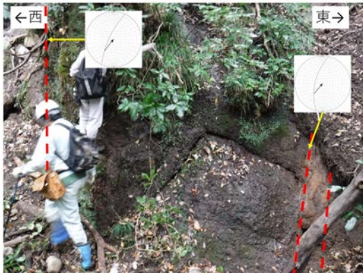
図5 左：②の露頭写真。点線が水中堆積テフラを切る断層、白囲み内は下半球投影された断層面の姿勢と運動センスを示す。運動センスは条線および断層近傍の面構造により推定された。右：露頭②で採取された断層ガウジを露頭スケッチ上に示した。
